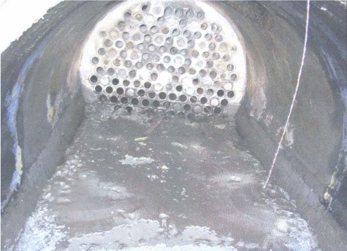
Figura 52: Resíduo pastoso de cor cinza na seção inferior do carretel
