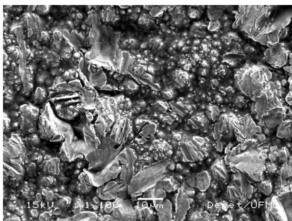
Figura 128 – Micrografia do eletrodepósito de níquel; DC =8.0 A/dm 2 ; aumento 1000 x.
