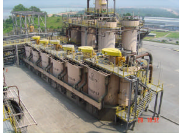
Figura 5.6 - Colunas “cleaner” e células “scavenger do cleaner” - Sossego
