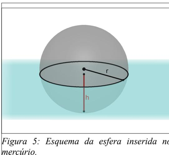
Pelo princípio de Arquimedes temos que  $\rho_A V_e = \rho_{Hg} V_{Hg}$ , onde  $V_e$  o volume da esfera e  $V_{Hg}$  é o volume de mercúrio deslocado.
