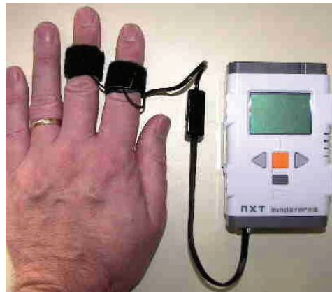
Figura 40 - Posição dos eletrodos do Lego NXT Mindstorms
