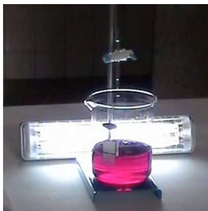
Figura 29 – Titulação ácido-base. Uma torneira deixa cair base sobre o ácido contido no béquer (com o líquido rosa). Ao fundo uma lâmpada de emergência ligada.
