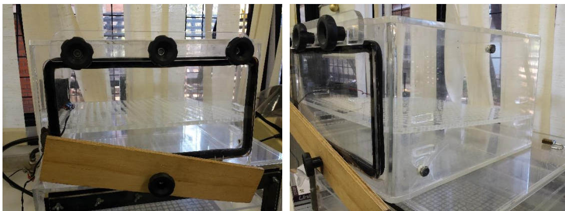
Figura 29 - Estufa lotada no Laboratório de Ciências da Conservação (LACICOR) na UFMG utilizada para as aferições dos erro dos aparelhos datalogger utilizados nesta pesquisa de mestrado. Fonte: Christiane Santos.
