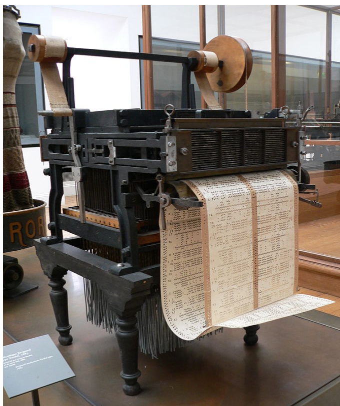
Figura 37: Tear mecânico Jacquard no "Musée des arts et métiers". Disponível em: < https://pt.wikipedia.org/wiki/Joseph-Marie_Jacquard > Acesso 12/02/2016
