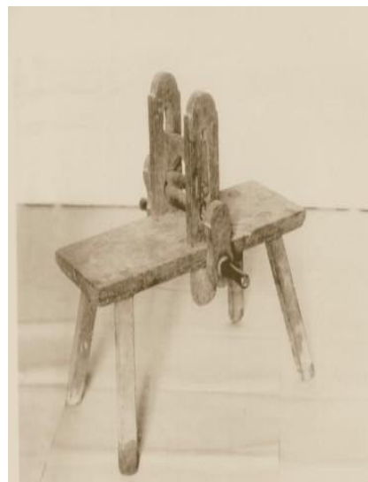
Primitivo descaroçador de algodão ( churka ). Origem: Cuiabá, Mato Grosso. [s.n.t.]. In: HOLANDA, 1995.
