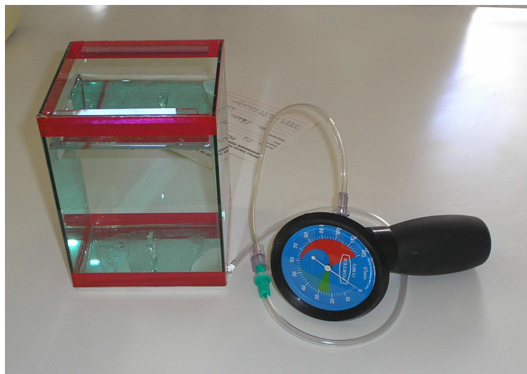
FIGURA 2 - Equipamento utilizado para estudo da pressão de ruptura à distensão por ar
