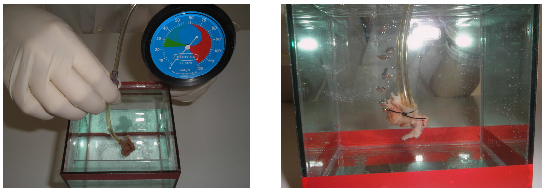
FIGURA 8 - a) Mensuração da pressão de ruptura à distensão por ar;
