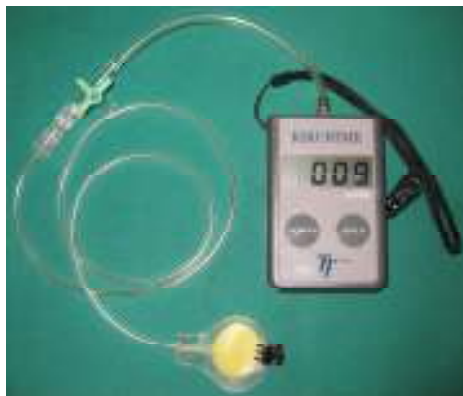
Figura 7 – Fotografia do Kikuhime (MediTrade, Soro, Dinamarca) que mostra momento da medida de pressão de um dispositivo compressivo utilizando o menor transdutor de pressão do aparelho.
