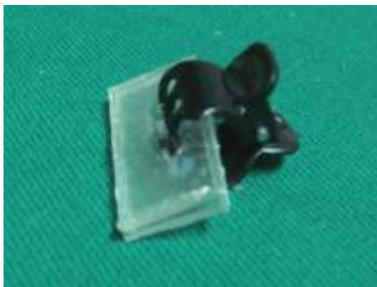
Figura 5 – Fotografia do dispositivo de compressão composto por placas de plástico transparentes fixadas em pequena garra provida de mola espiral que proporciona compressão entre as duas placas plásticas.
