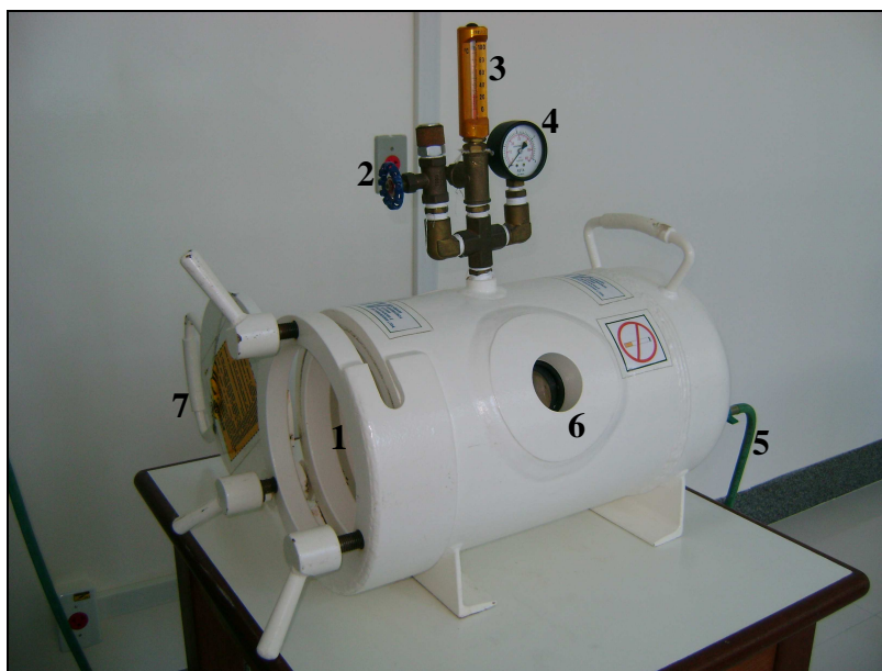
FIGURA 2 - Câmara hiperbárica (CHV- Vitória Montadora e distribuidora Ltda- Vitória-ES) com formato cilindro capsular construída com aço carbono.
