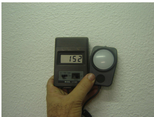
FIGURA 2 – Medição do iluminamento na parede
