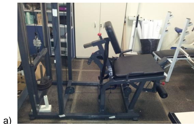
FIGURA 3 – Aparelho extensor de joelhos adaptado (a) e potenciômetro fixo no eixo de rotação (b)
