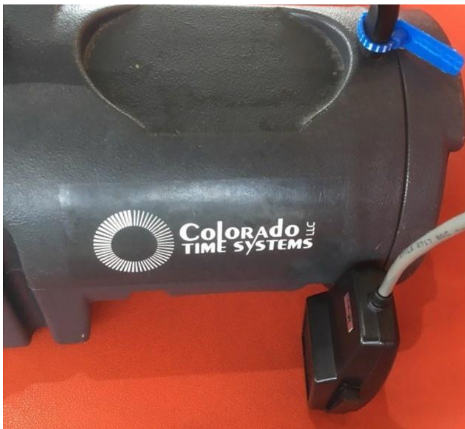
Figura 10 - Sistema de cronometragem eletrônico Colorado - TimeSystem® - dispositivo que emite um sinal sonoro e um sinal visual
