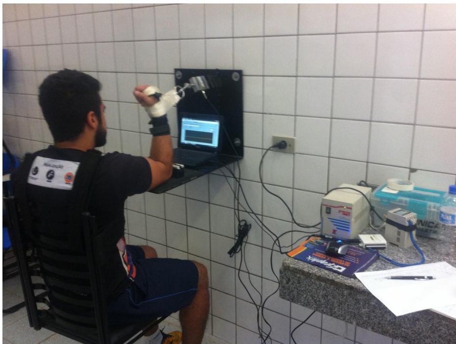
Figura 3 – Layout da sala de coleta de dados com célula de carga de tração e compressão, amplificador de dados, conversor analógico digital e computador para aquisição dos dados.
