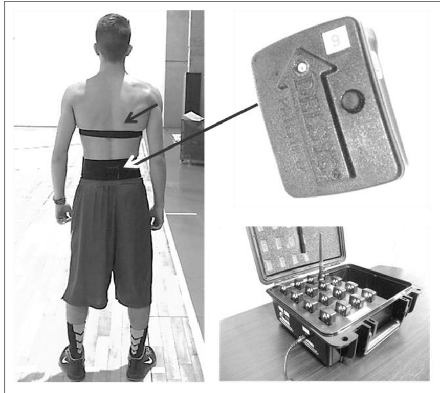
Legenda: à esquerda, atleta vestindo o cardiofrequencímetro (seta menor) e a cinta elástica contendo o acelerômetro (seta maior). À direita superior, uma unidade do acelerômetro utilizado na pesquisa. À direita inferior, a base do equipamento para captação *wireless* da aceleração e interface com o computador.
