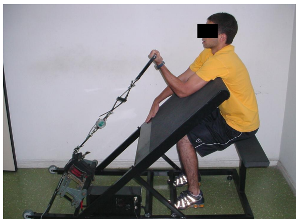
FIGURA 11 - Aplicação de vibração mecânica na resultante da força muscular.
