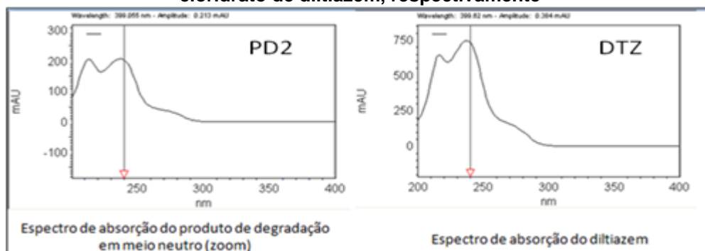
Figura 18 - Espectros de absorção para o produto de degradação em meio neutro e o cloridrato de diltiazem, respectivamente
