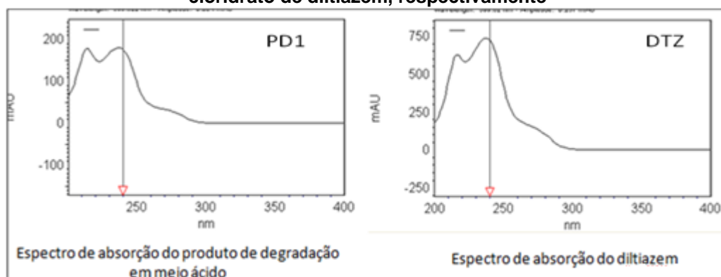
Figura 16 - Espectros de absorção para o produto de degradação em meio ácido e o cloridrato de diltiazem, respectivamente
