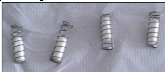
Figura 31 - Modelo de âncora utilizado para os testes de perfil de dissolução e dissolução das cápsulas magistrais contendo cloridrato de diltiazem
