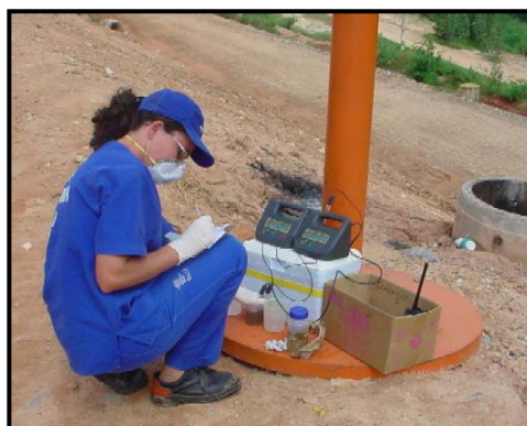
FIGURA 4.8: Medição dos parâmetros físicos-químicos da célula AC05
