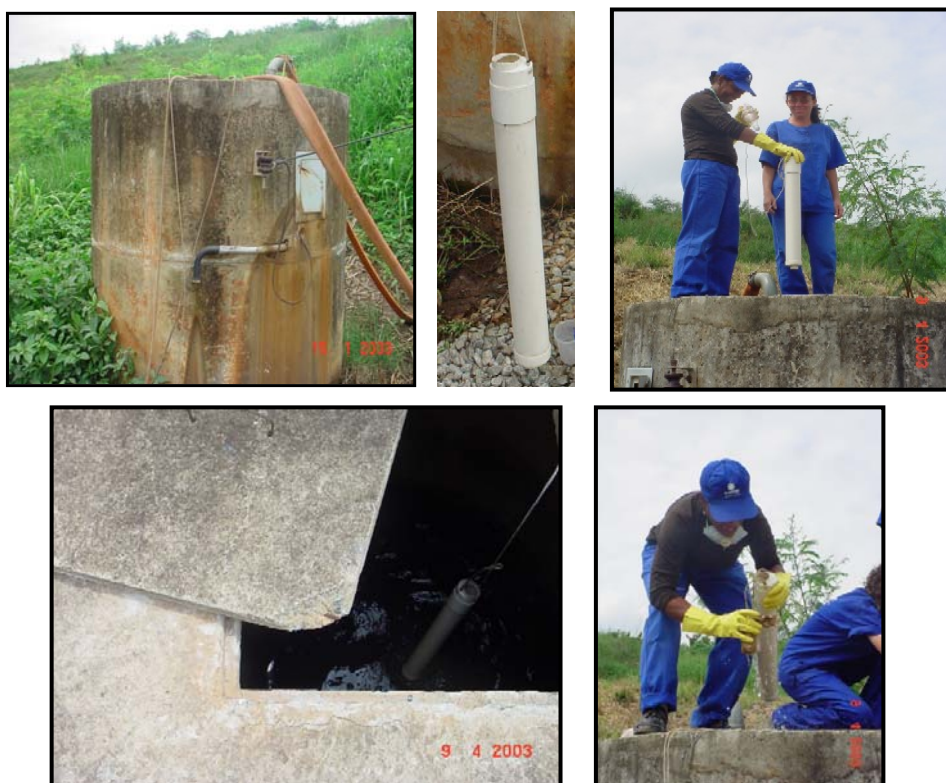
FIGURA 4.6: Amostragem do líquido lixiviado no piezômetro da célula emergencial
