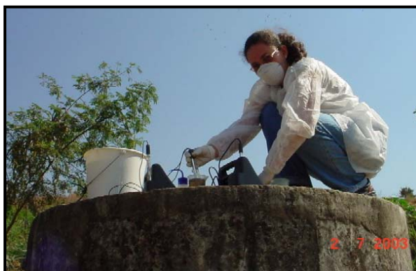
FIGURA 4.9: Medição dos parâmetros físicos-químicos da célula emergencial
