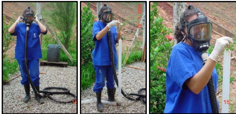
FIGURA 4.4: Máscara adaptada para respiração, durante as primeiras amostragens do líquido lixiviado da célula AC05
