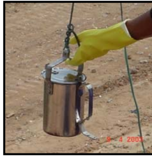
FIGURA 4.3: Jarra adaptada para coleta do líquido lixiviado da célula AC05
