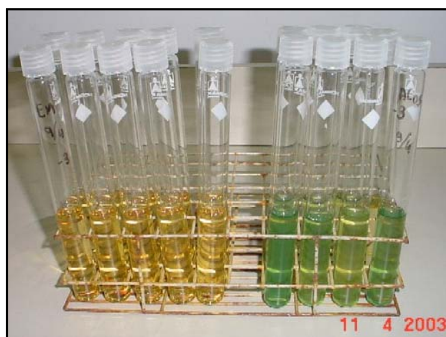
FIGURA 4.15: Detecção do grupo Enterococcus pela técnica de tubos múltiplos com (caldo Chromocult Enterococci)
