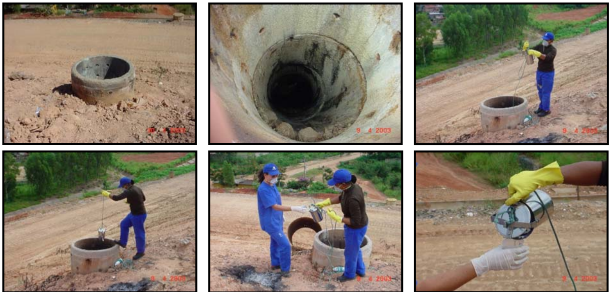
FIGURA 4.5: Amostragem do líquido lixiviado no piezômetro da célula AC05
