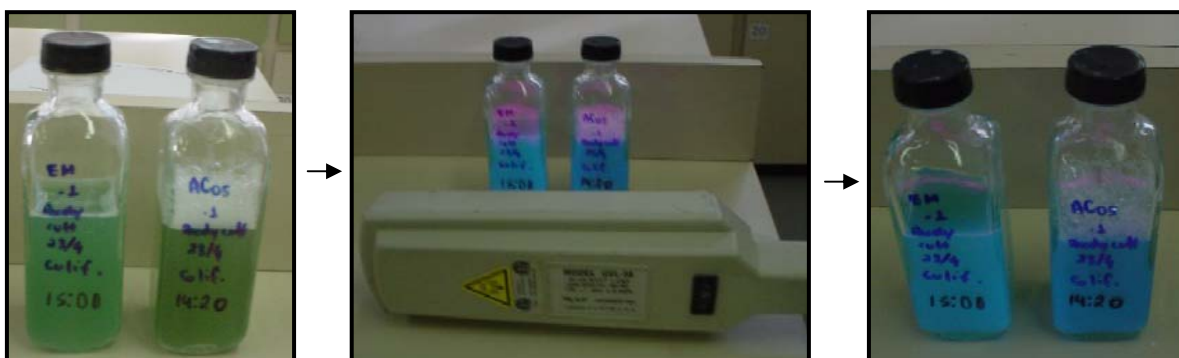
FIGURA 4.16: Detecção simultânea de coliformes fecais e Escherichia coli pela técnica de presença e ausência com substrato cromogênico Readycult Coliformes
