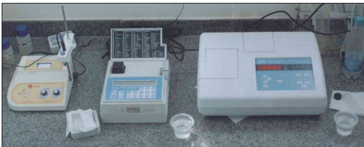
Figura 4.4 – Aparelhos utilizados nos ensaios: pH-metro (à esquerda), espectrofotômetro (ao centro) e turbidímetro (à direita).
