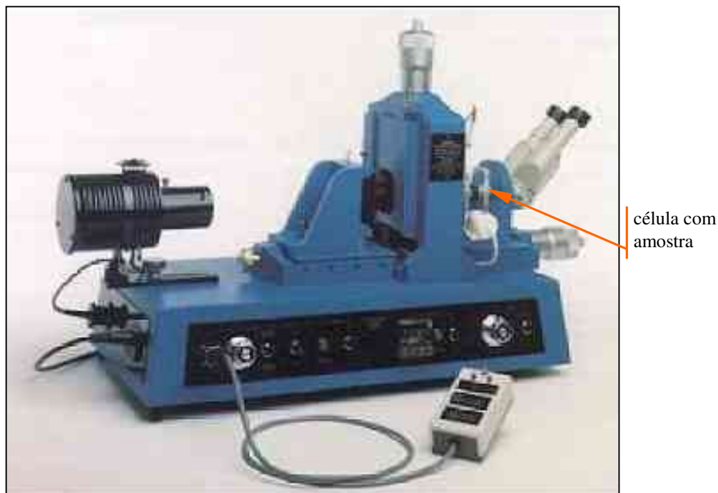
Figura 4.5 – Célula microeletroforética – Rank and Brothers Mk II – célula plana (quartzo), eletrodos enegrecidos de Pt.
