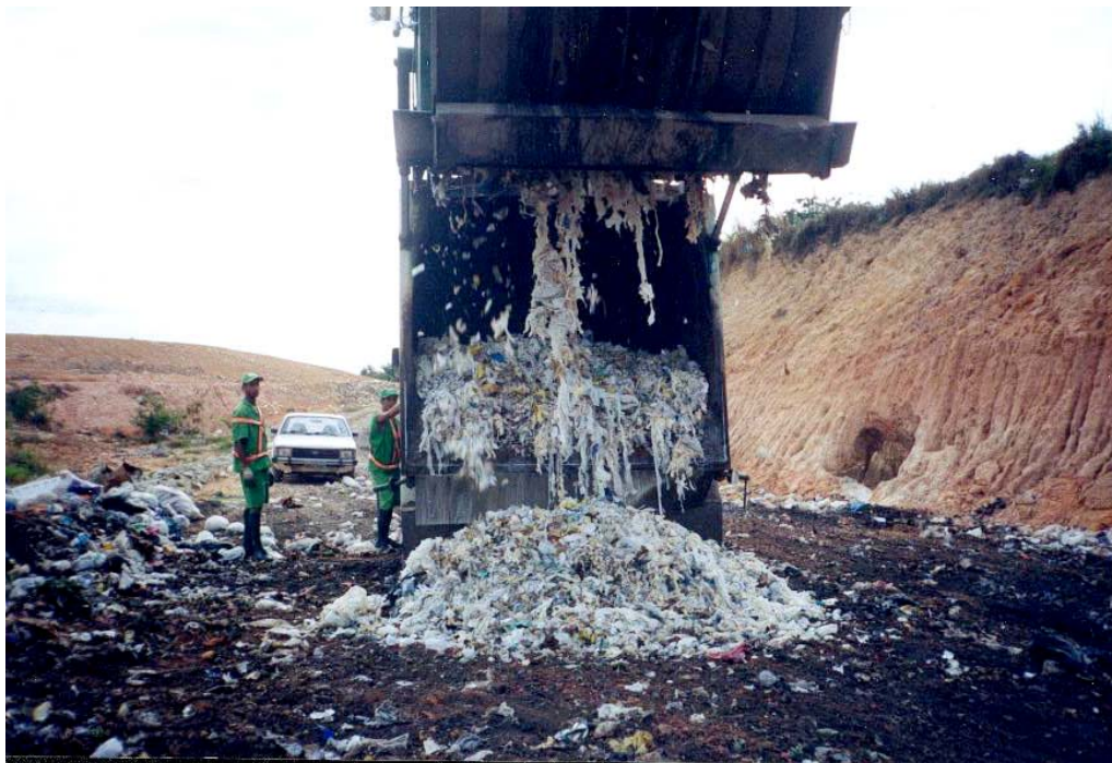
Figura 13 - Despejo dos RSS após autoclavação e trituração para descaracterização dos RSS (outubro/2004)
