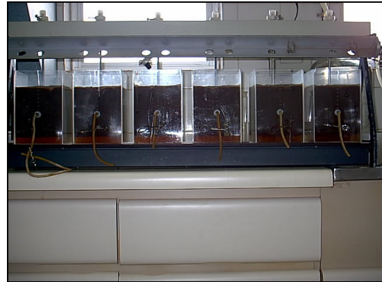
Figura 4.18 –Lodo no jarteste para acidificação e mistura
