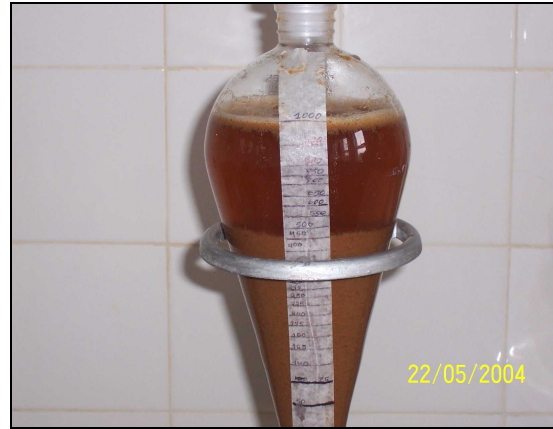
Figura 4.20 – Sedimentação do resíduo não solubilizado no balão.
