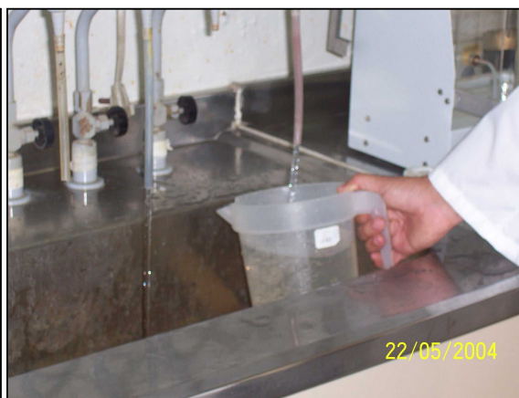
Figura 4.16 - Retirada de amostra de água bruta no laboratório da ETA Rio Manso
