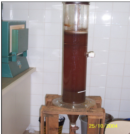
Figura 4.21 – Sedimentação do resíduo não solubilizado na coluna.
