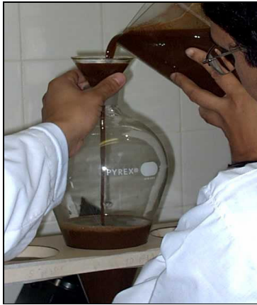
Figura 4.19 – Transferência do lodo do jarteste para o balão de sedimentação.
