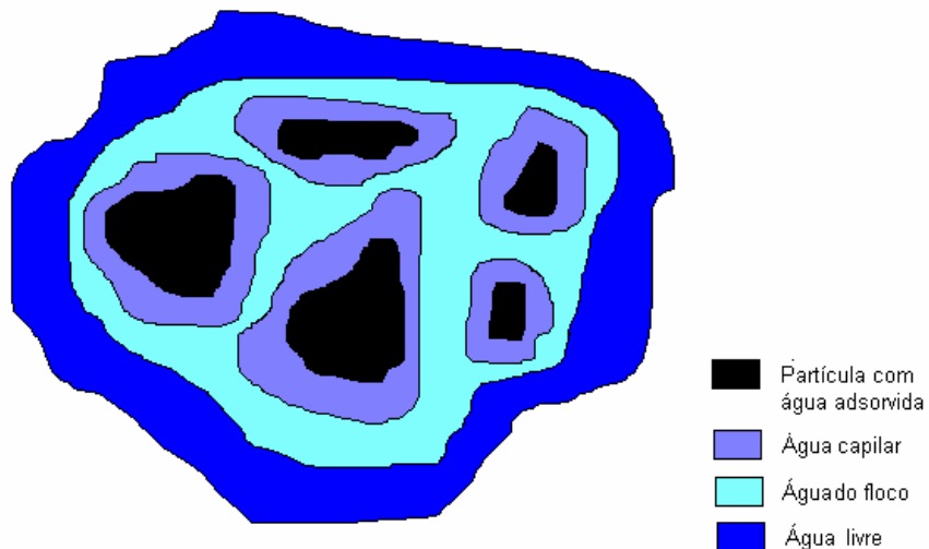
Figura 3.1. – Distribuição da água no floculo do lodo. Fonte: Adaptado de Smollen e Kaffar apud Realli (1999).
