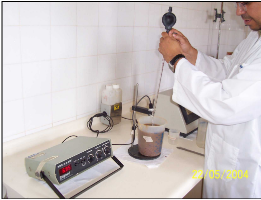
Figura 4.17 – Aplicação de ácido no lodo adensado para definição de dosagem
