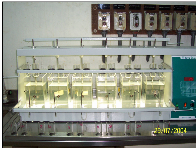
Figura 4.24 – Ensaio em jarteste
