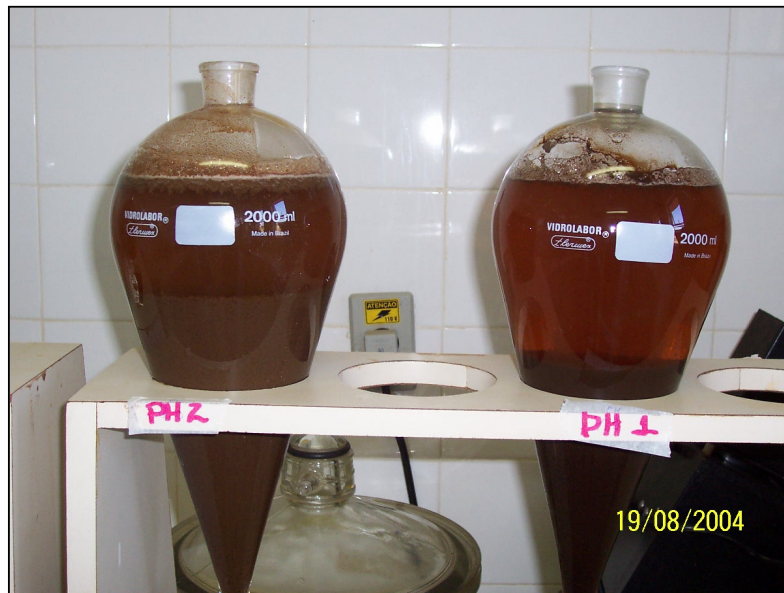
Figura 5.22 – Separação do resíduo e sulfato de alumínio recuperado em pH 2 e pH 1 no balão de sedimentação
