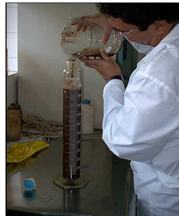
Figura 4.22 –Medida volumétrica do resíduo não solubilizado em proveta graduada.
