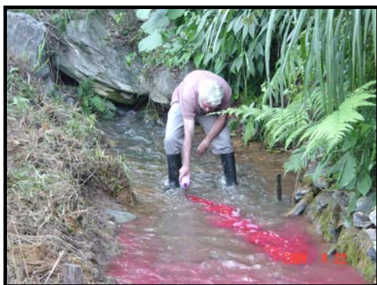
Foto 61 - Medição de vazão no Tadinho com 5 ml de Rodamina WT.
