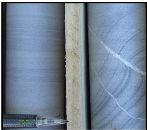
Foto 47 - Laminado e falhado (FPZ-09).
