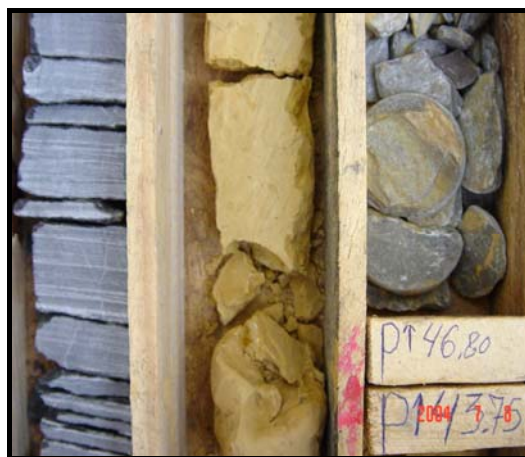
Foto 48 - Cavernas preenchidas (FS-141).
