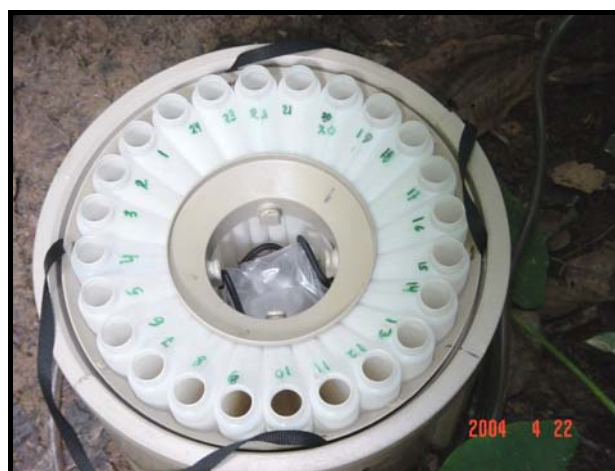
Foto 02 - Detalhe da parte interna do coletor.
