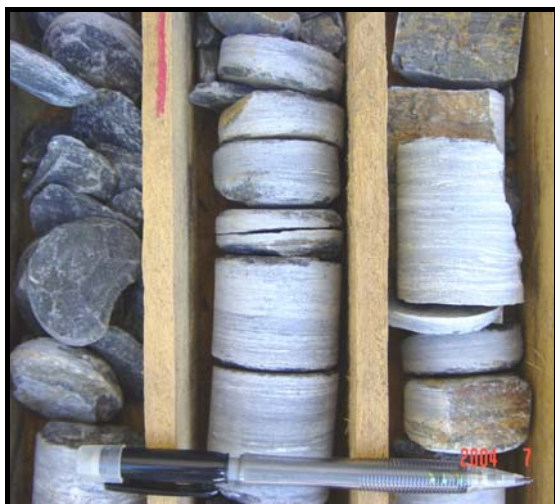
Foto 45 - Fraturas e fendas (FPZ-08).
