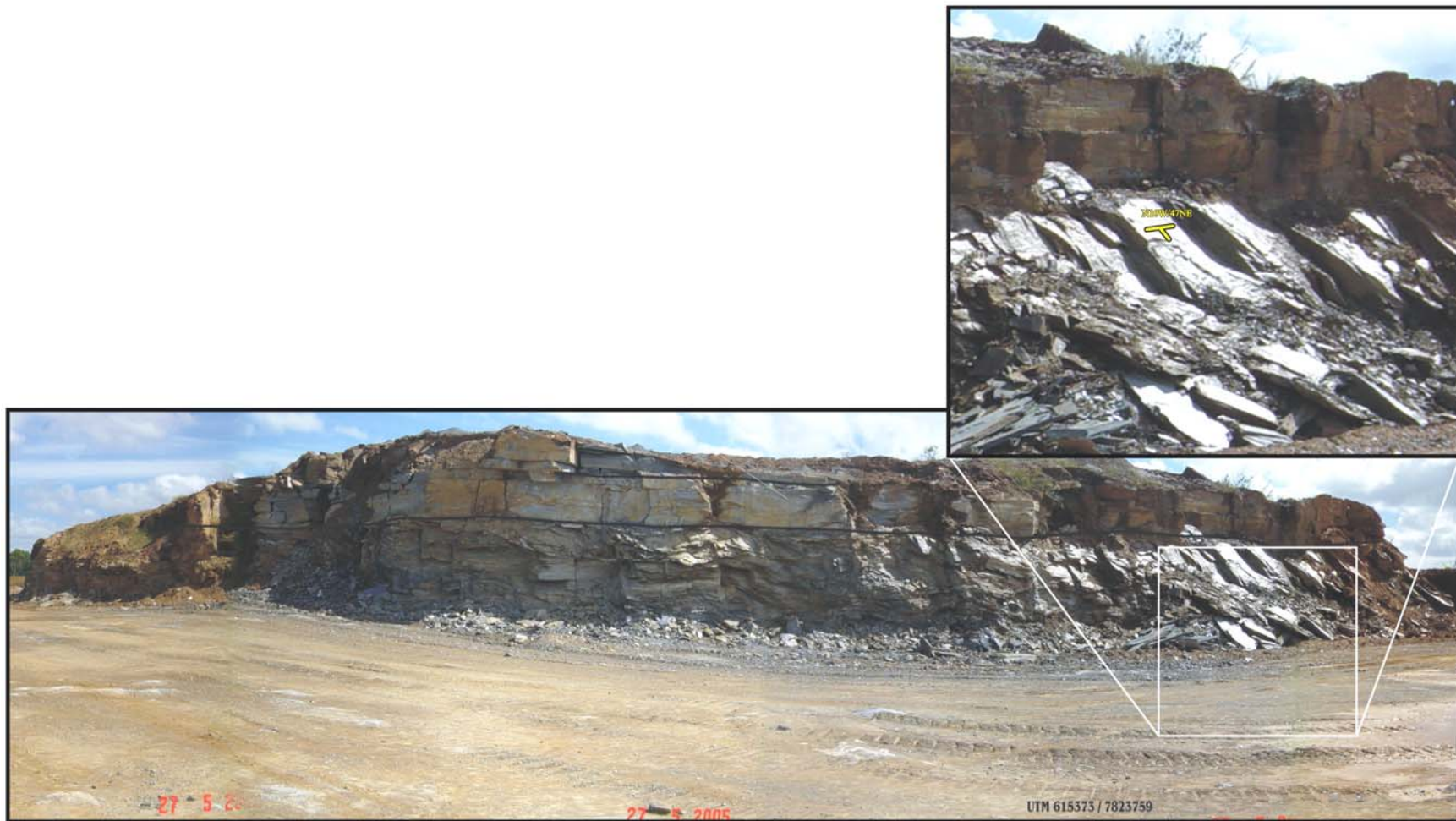
Foto 24 - Mina Lapa Vermelha, panorama do topo da frente de lavra atual. Cálcio filitos deformados em níveis interestratais, carbonosos localmente, exibindo dobramentos isoclinais apertados, com mergulho mais acentuado da foliação ( S_n = N10W/47NE ). Xisto carbonático sobreposto, subhorizontal.
