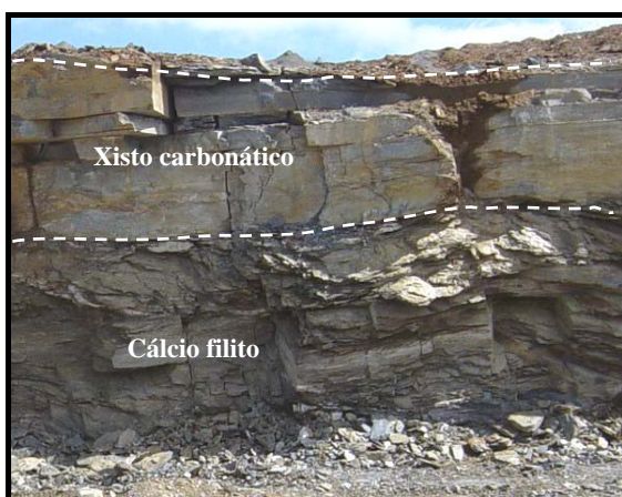
Fotos 18 e 19 - Xisto carbonático maciço sobre cálcio filito carbonoso deformado (dobrado).
