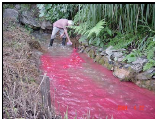
Foto 62 - Dispersão do corante na medição de vazão do Tadinho.
