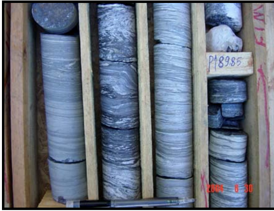
Foto 31 - Deformado e grafítico (FPZ-16).
