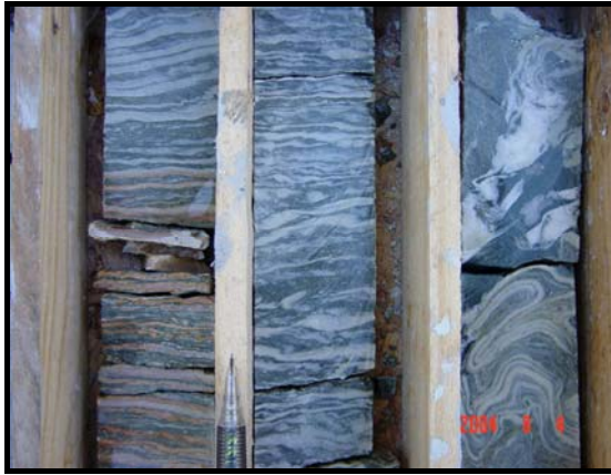
Foto 41 - Fraturado e dobrado (FS-16).
