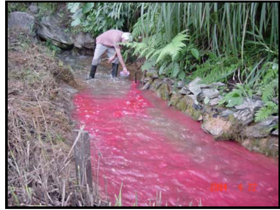
Foto 62 - Dispersão do corante na medição de vazão do Tadinho.
