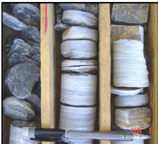
Foto 45 - Fraturas e fendas (FPZ-08).
