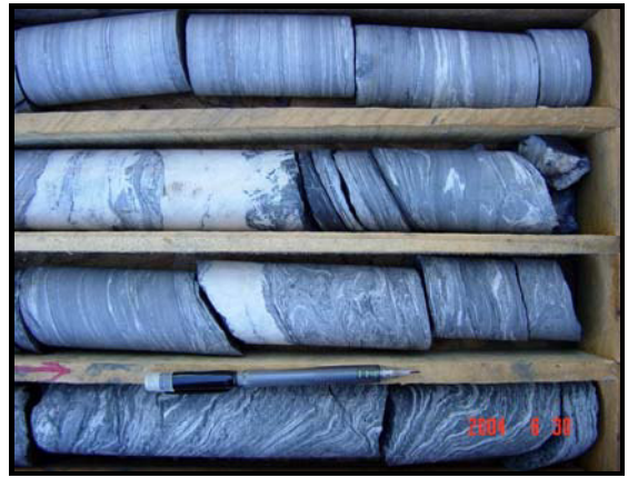
Foto 32 - Falhado, com brechas (FPZ-16).
