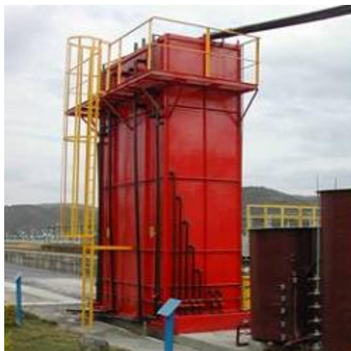
Figura 4.1 – Reator UASB em escala de demonstração utilizado na pesquisa
