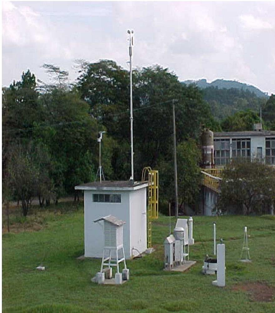
**FIGURA 4.3** - Estação meteorológica.
