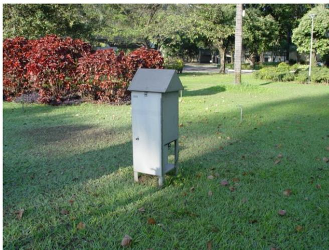
**FIGURA 4.1** - Equipamento *Hi vol* utilizado no monitoramento de PTS em Ipatinga.
