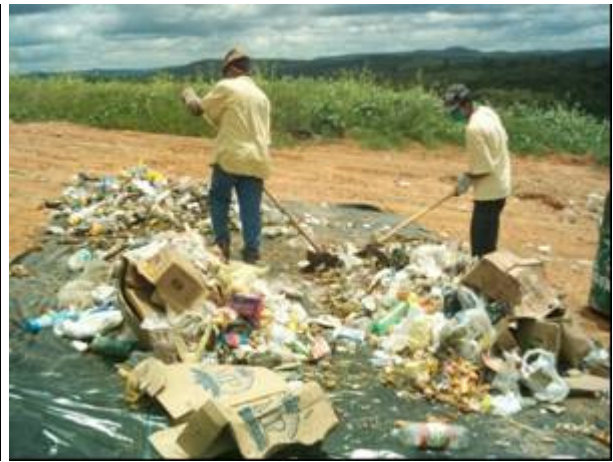
Figura 25 – Técnica de quarteamento aplicada na caracterização de RSU por funcionários da limpeza pública.
