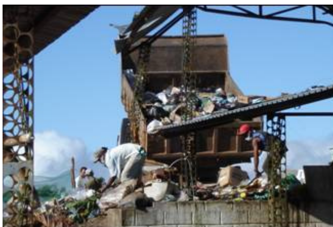
Figura 29 – Vista geral da descarga de RSU pelo caminhão de coleta na UTC de Padre Paraíso (até agosto de 2006).
