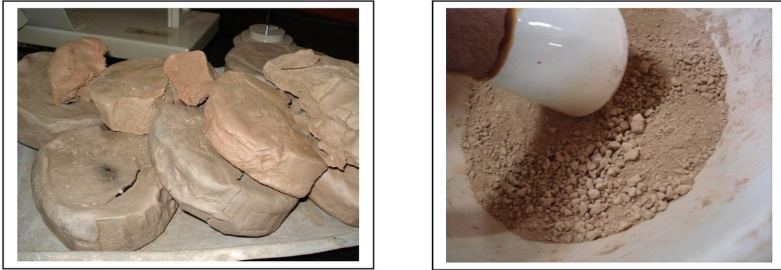
**Figura 4.3** – Preparação da argila para utilização nos corpos de prova
