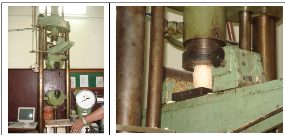
**Figura 4.4** - Ensaio de compressão em corpo de prova.
