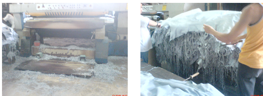
Figuras 4.4 e 4.5 - Extrações das aparas de couro: à esquerda a extração automática e à direita a extração manual.
