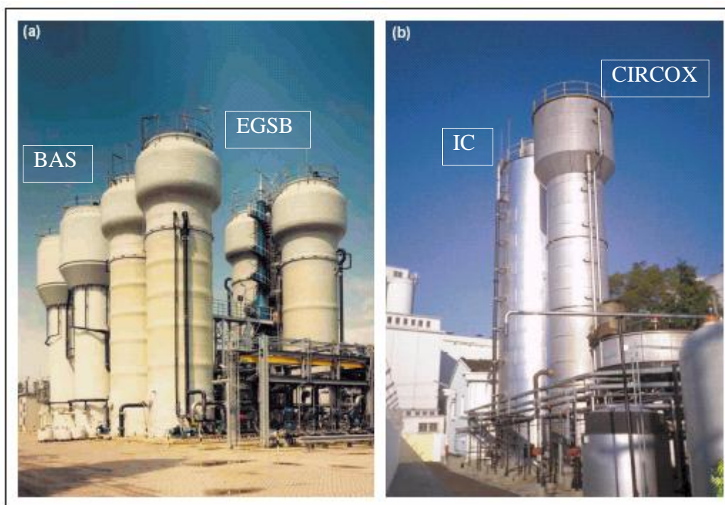
Figura 3.5 – Vista de reatores em escala plena; (a) sistema EGSB+AIRLIFT (b) sistema IC+CIRCOX, tratando efluente de cervejaria no Brasil. Fonte: NICOLELLA (2000)
