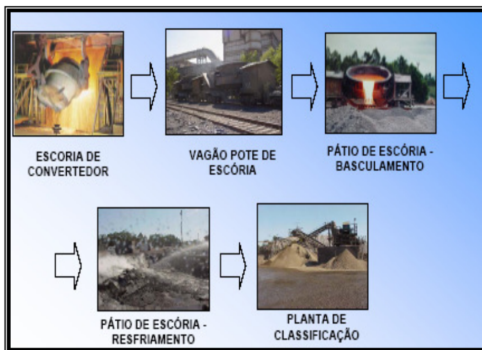
Figura 3.8 - Geração e tratamento da escória de aciaria Fonte: SILVA, 2006.
