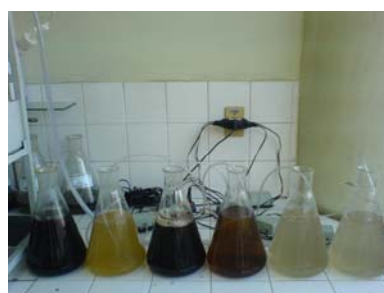
Figura 4.12 - Reatores aeróbios utilizados na determinação da DQO inerte.
