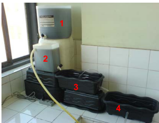
Figura 4.17 - Aparato experimental utilizado na avaliação da eficiência de remoção de DQO solúvel em escala de bancada.
