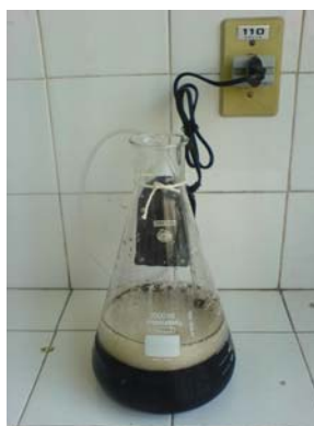
Figura 4.4 - Reatores aeróbios utilizados no monitoramento da DQO.
