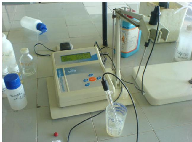
**Figura 4.7** – potenciômetro digital utilizado nos ensaios experimentais.
