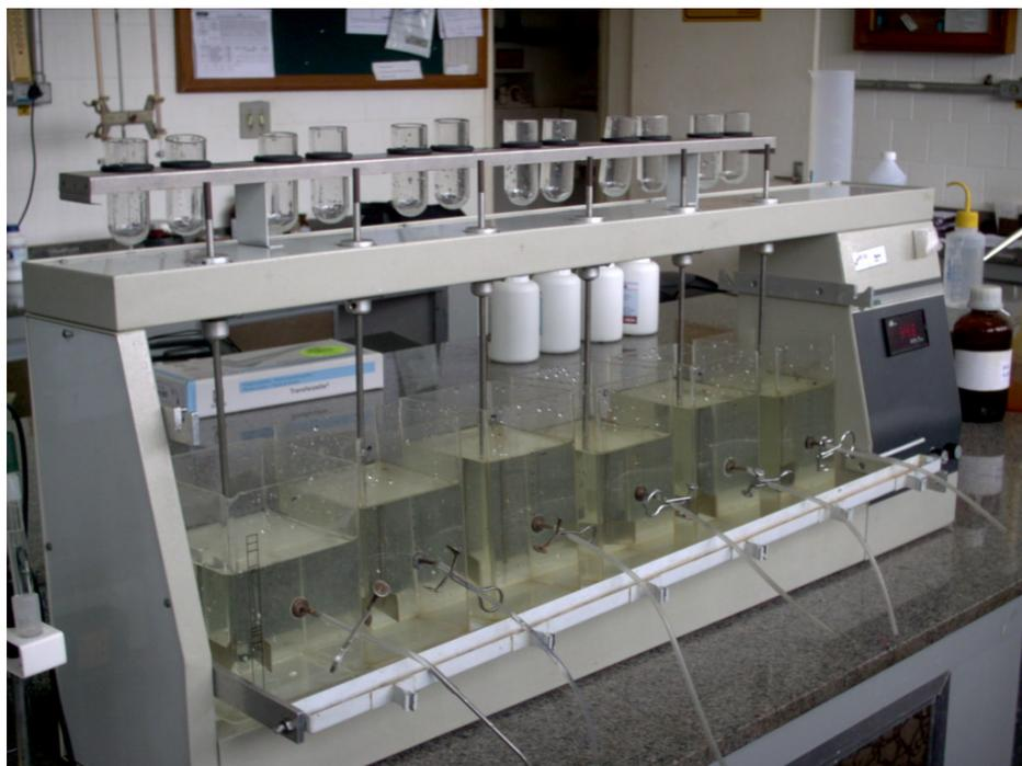
**Figura 4.3** – Aparelho de jarteste utilizado para os ensaios de sedimentação.
