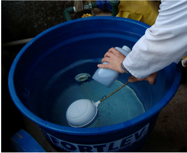
Figura 4.23: Coleta de água de estudo na caixa de nível constante.
