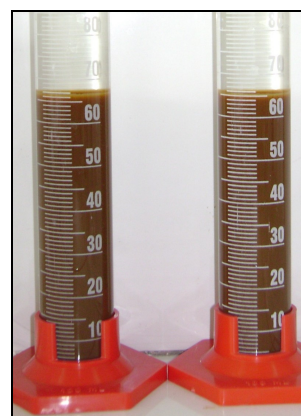
Figura 5.28: Resultado da decantação do lodo após 72 horas
