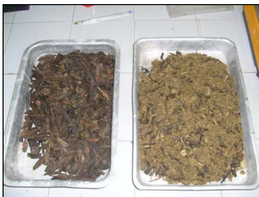
Figura 4.28: Separação manual da mistura coletada no teste de queima
