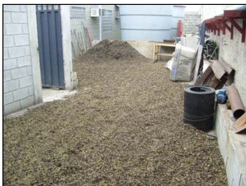
Figura 4.24: Secagem da mistura do biocombustível antes do teste de queima
