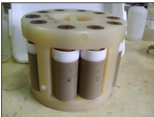
Figura 4.14: Carrossel com os frascos utilizados para a digestão das amostras
