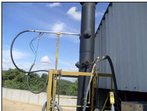
Figura 4.25: Sondas instaladas na chaminé para o monitoramento dos poluentes durante o teste de queima do biocombustível
