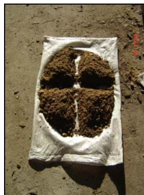
Figura 4.21: Quarteamento do material para análises em laboratório
