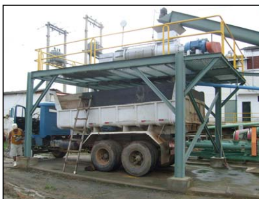
Figura 4.13: Coleta de conteúdo ruminal após a prensagem
