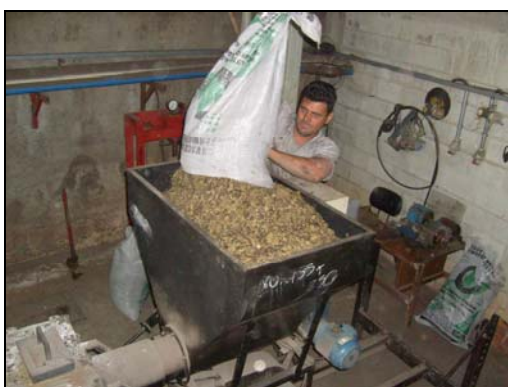
Figura 4.26: Alimentação do combustor com a mistura
