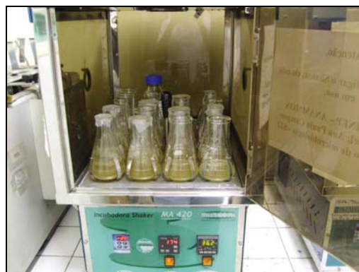
Figura 4.17: Agitação das amostras no agitador para a solubilização de cloretos
