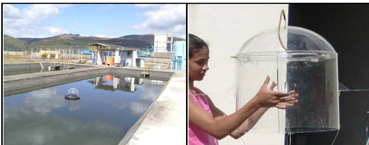
Figura 4.9 – Campânula de captura de amônia volatilizada instalada na LP -1
