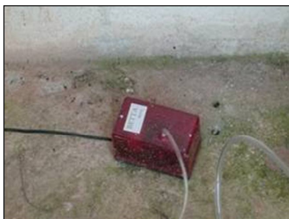
Figura 4.11 – Compressor utilizado para arraste de amônia volatilizada
