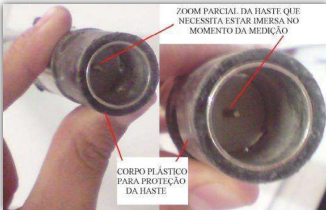
Figura 4.18 – Visualização do condutivímetro. No detalhe a haste metálica.
