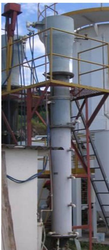
**Figura 4.2:** Reator UASB escala piloto.
