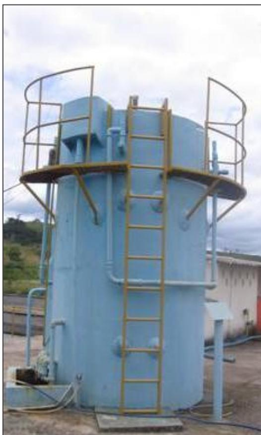
**Figura 4.1:** Reator UASB escala demonstração.
