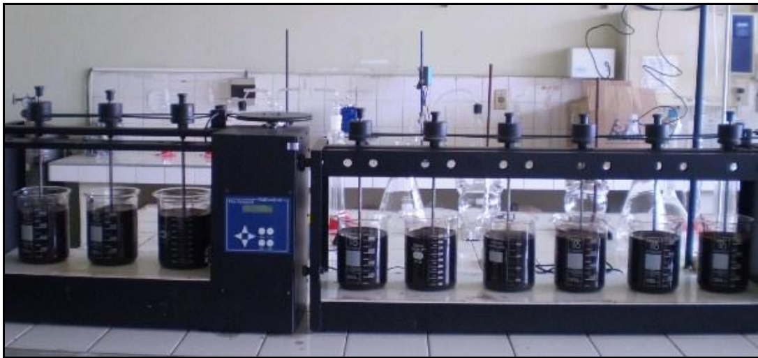
Figura 4.3: Montagem Jar-Test utilizada nos experimentos de adsorção
