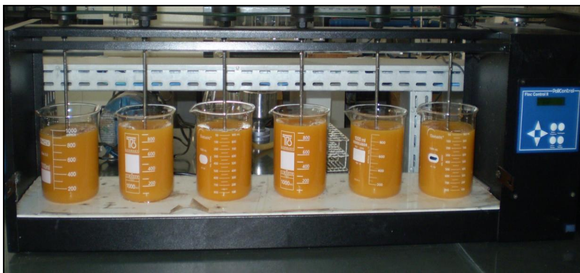
Figura 4.4: Montagem Jar-Test utilizada nos ensaios de Fenton homogêneo
