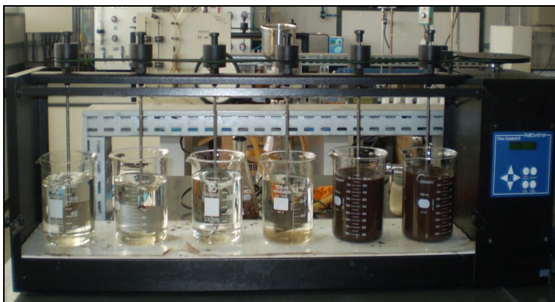
Figura 4.5: Montagem Jar-Test usada nos ensaios de Fenton no lixiviado e heterogêneo
