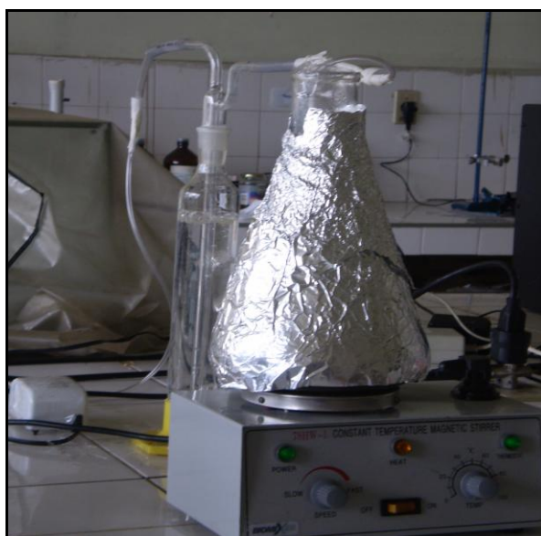
Figura 4.2: Montagem do Reator do Teste Zahn-Wellens
