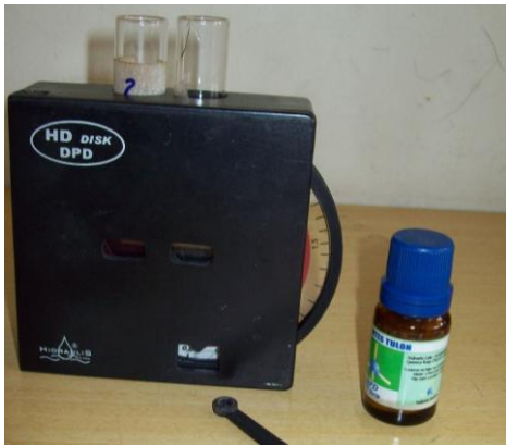
Figura 4.11 – Comparador visual para cloro HD DISK DPD utilizado para amostras das ETAs A e B.
