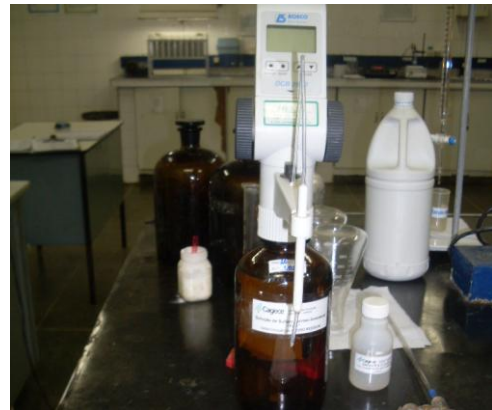
Figura 4.12 – Medidor de cloro BOECO DCB 2500 utilizado para amostras da ETA C.
