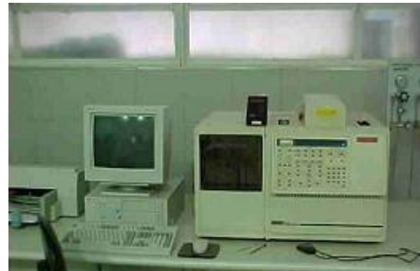
Figura 4.14 – Cromatógrafo a gás com detector de captura de elétrons, Varian 3600 CX. Fonte: Paschoalato, 2005.
