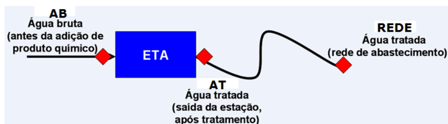
Figura 4.5 – Pontos de amostragem de água bruta e tratada.
