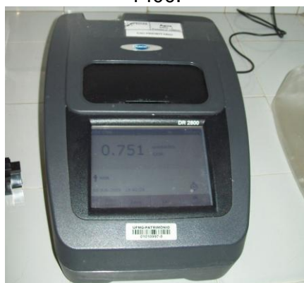
Figura 4.9 – Espectrofotômetro HACH DR 2800 utilizado para determinação de cor aparente de amostras das ETAs A e B.
