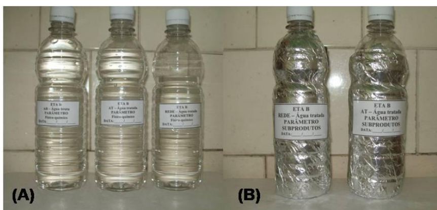
Figura 4.6 – Frascos utilizados para coleta de amostras de água bruta e tratada. (A) Amostras para análises dos parâmetros físico-químicos e (B) Amostras para quantificação de subprodutos.
