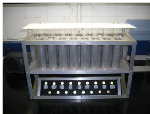
Figura 4.10 – Comparador visual utilizado para determinação de cor aparente de amostras da ETA C.
