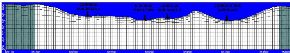
FIGURA 7.4 – Configuração do Domínio de Cálculo no Plano Vertical – Corte na Coordenada UTM N7.778.350
