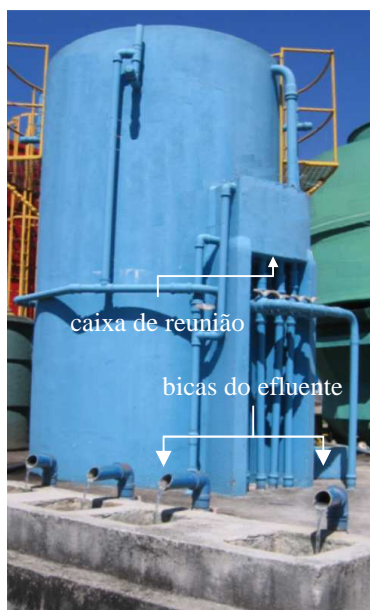
Figura 6.1 - Vista do reator UASB, escala demonstração ( R_{demo} )
