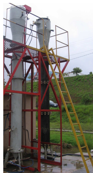
Figura 5.3 - Vista dos reatores UASB, escala piloto (R conv e R mod )
