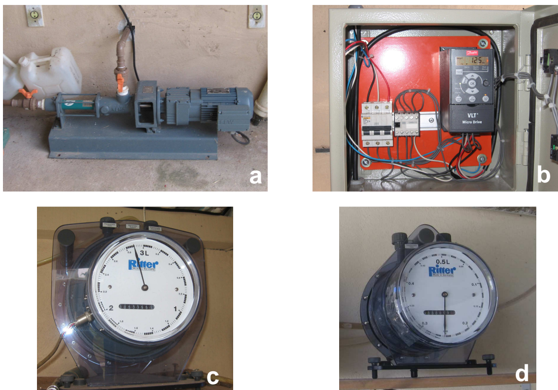
Figura 7.1 – Fotos de equipamento usados para bombeamento de vazão constante para o reator (a: bomba deslocamento positivo; b: inversor de frequência) e para medição da produção de biogás (c: gasômetro Ritter tipo TG3; d: gasômetro Ritter tipo TG05)
