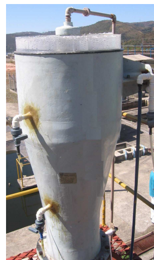
Figura 6.2 - Vista do decantador do reator UASB, escala piloto ( R_{conv} )
