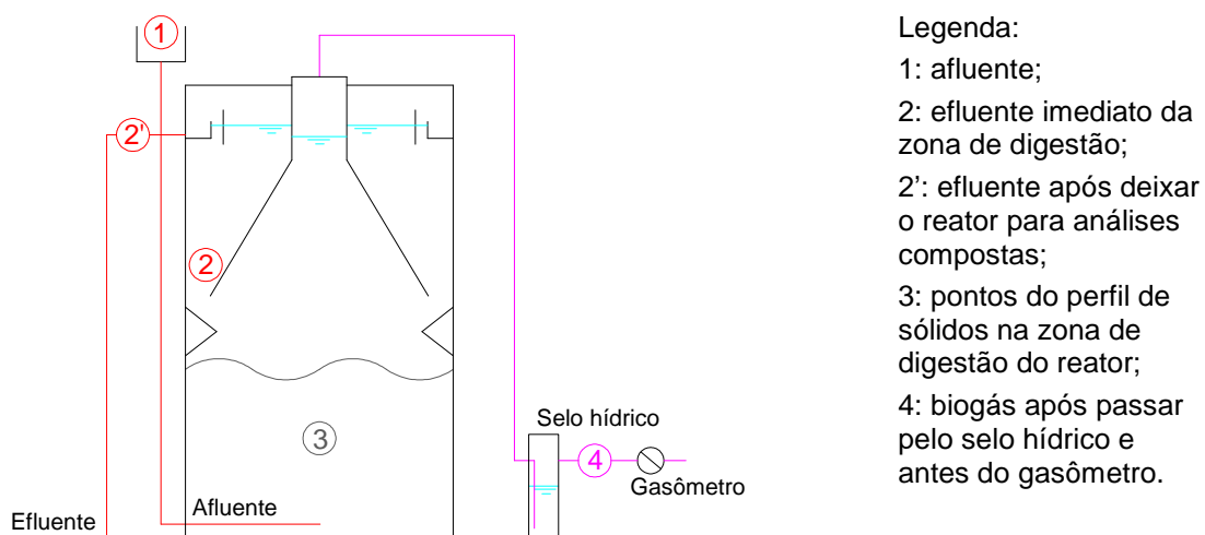
Figura 7.2 - Corte esquemático dos reatores mostrando os pontos monitorados
