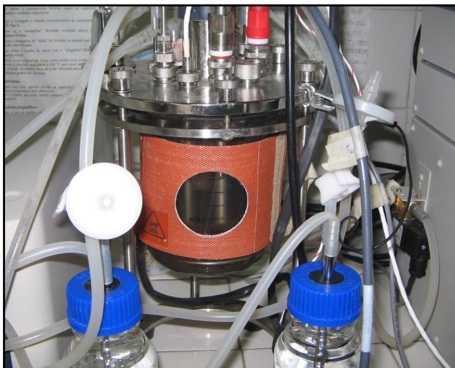
Figura 4.3 – Foto do fermentador operado como Reator em Batelada Sequencial usado para o enriquecimento de bactérias anammox
