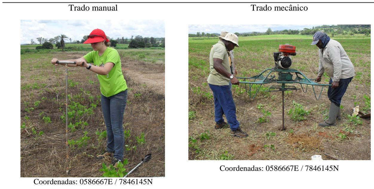
**FIGURA 7.21:** Trado manual e Trado mecânico utilizados na execução dos furos de sondagem.
