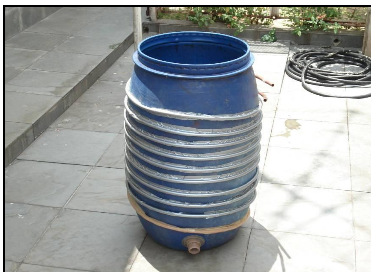
Figura 4.11 – Reator anaeróbio sendo revestido com serpentina de cobre, por sua vez coberta com fita adesiva específica
