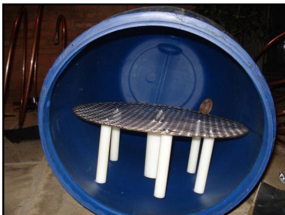
Figura 4.9 – Colocação de tela na base dos tanques – foto 1
