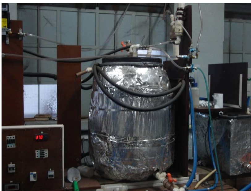
Figura 4.15 – Reator anaeróbio – detalhe
