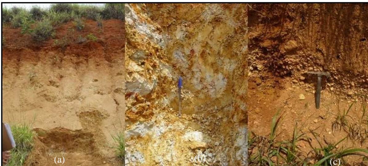
Figura 6.28 – Exposição do saprólito, e detalhes do mosqueado e do nível de cascalho
