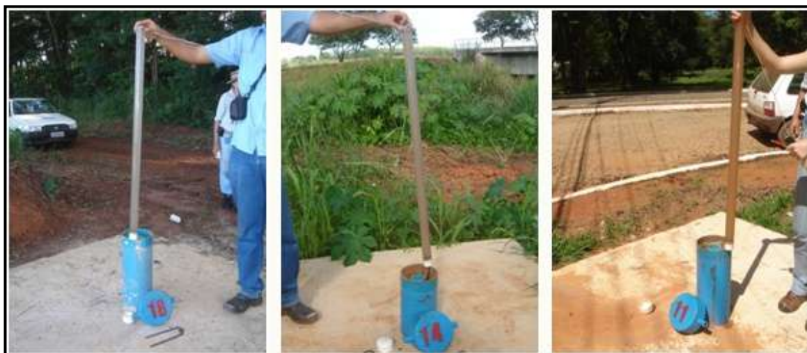
Figura 8.92 – Turbidez aparentes nas águas dos poços de monitoramento
