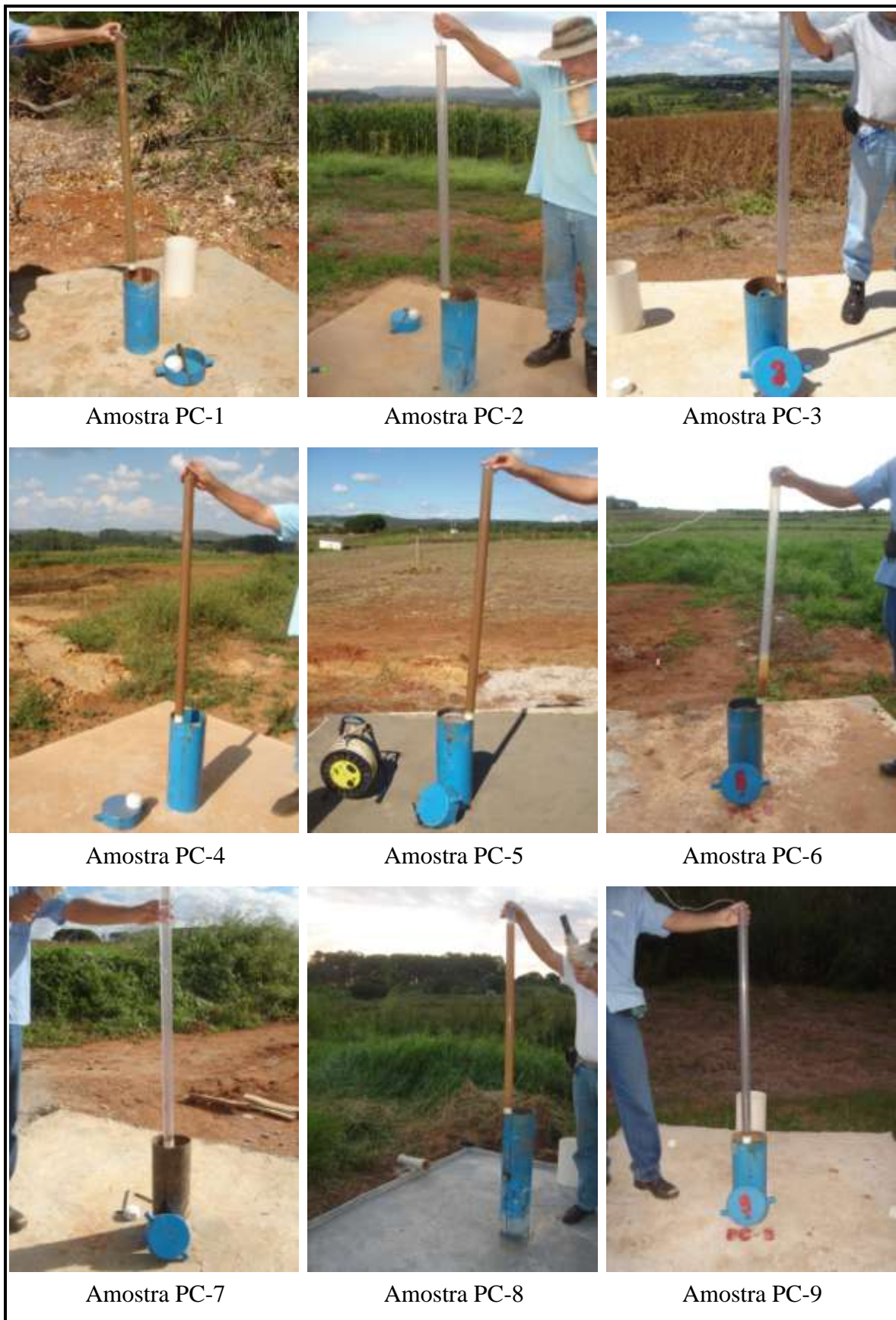
Figura F67 Turbidez aparentes da água nos poços de monitoramento PC-1 a PC-9
