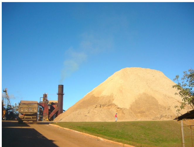
Figura 31: Bagaço de cana-de-açúcar utilizada para autogeração de energia na produção de etanol
