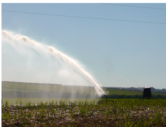
Figura 25: Aplicação de vinhaça por meio de conjunto motobomba
