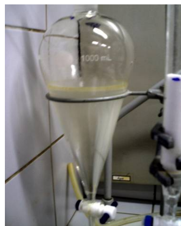
Figura 7.39 - Separação das fases aquosa (fase de maior volume) e orgânica (sobre a fase aquosa) durante período de repouso.
