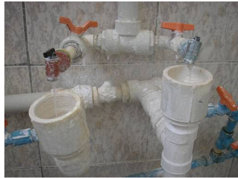
Figura 8.27 - Adição de solução de cal para ajuste de pH.
