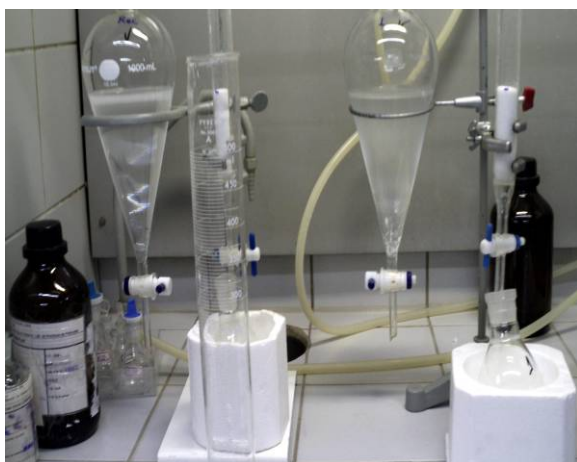
Figura 7.38 - Separação das fases orgânica e aquosa nas amostras menos turvas.
