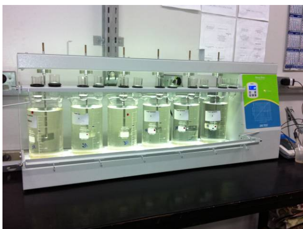
Figura 7.26 - Ensaio de Jar Test com água do manancial do distrito de Dom Corrêa (Córrego João Bento).
