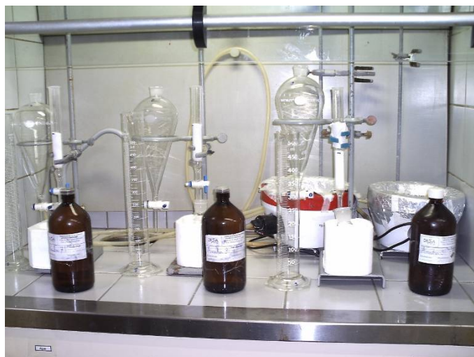
Figura 7.37 - Montagem das vidrarias para extração.
