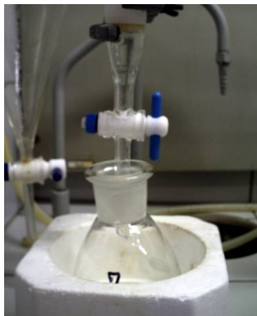
Figura 7.40 - Extrato orgânico filtrado sendo coletado em balão.
